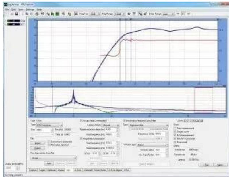
FIR-Capture 是基于个人电脑的、功能强大的测量软件工具，可生成滤波器参数、FIR 系数、FFT 卷积滤波器、线性&混合相位滤波器和砖墙型滤波器 (brick wall filter)。
