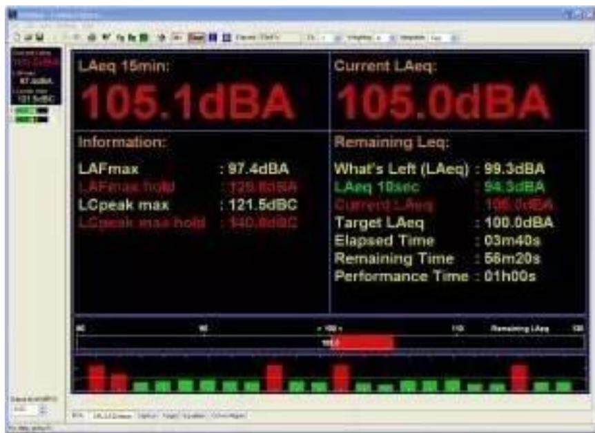
Tuning-Capture 衍生自 Room-Capture，是用于音箱系统调试的测试软件。Tuning-Capture 使用时域线性扫频，是一款高性价比、直观的软件。它可以满足入门级需求，但同时具备超高解析度。一系列新开发的分析工具可提供快速、精确的校准信息；延时探测器包含群延时和倒频谱分析、滤波器优化以及带直方图的声压级计量等。
