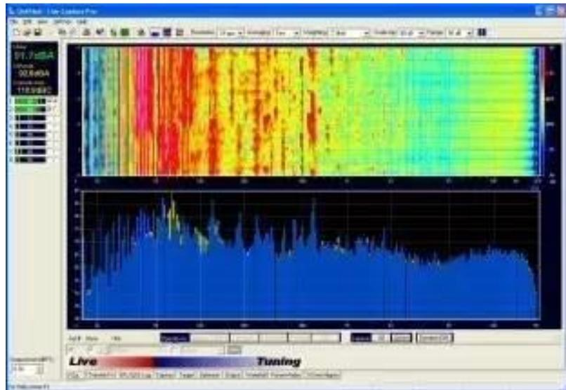
Live-Capture Pro 是一款使用简单的、基于个人电脑的软件工具，用于实时现场音响测量。Live-Capture Pro 最多可同时测量 8 通道信号的频域和时域。可使用节目源（音乐和语音），在演出前或演出时，观众在场的情况下进行测量。Live-Capture Pro 还使用传统的最长序列（MLS）和线性扫频（Chirp）测量。被测量的通道可通过空间平均，计算出实时的单一传递函数。
