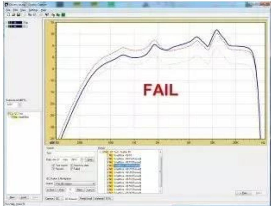
Quality-Capture 可测试失真、复合音、脉冲和频率响应以及阻抗。它还可以同时在频域和时域进行多通道测量，例如，测量生成具有 4 个输入通道的频率响应和阻抗曲线。
