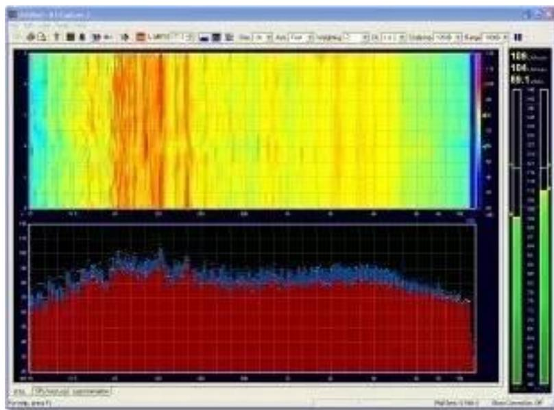
RT-Capture 结合了实时分析器 (RTA) 和声压级 (SPL) 测量。RT-Capture 使用标准的个人电脑声卡, 并支持两只话筒测量。RT-Capture 录制带声压级数据 (如 Leq、Lamax、Lamin) 的日志文件, 并可录制压缩的声音文件, 对声压级进行自我管理。
