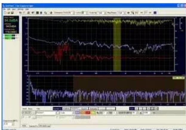
Live-Capture Light 衍生自功能强大的 Live-CapturePro，是一款使用简单的、基于个人电脑的软件工具。它专为扩声系统优化而设计，包括大量独特的分析工具，可快速提供精确的调试信息。完整的功能套件包括带群延时和倒频谱分析的延时探测器、自动均衡探测器和声压级日志。
